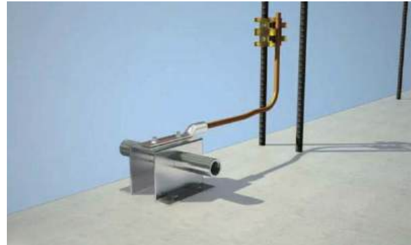
2. 동관단자/철근콘크터 접지선 고정
